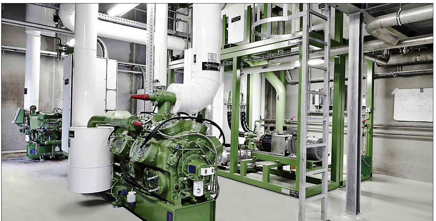
Laboratoriet på 700 m 2 består af specialdesignede klimakamre og prøvestande, der kan teste varmepumper med en kapacitet op til 40 kW.
